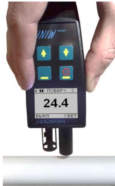
Рисунок 2.4 – Изображение прибора при измерении температуры поверхности
