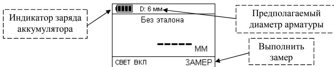
Рисунок 2.10 – Выполнение замера без применения эталонного образца
