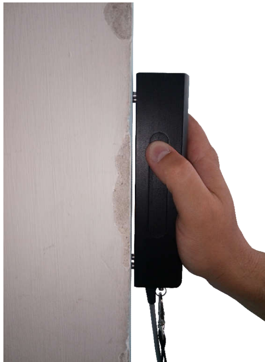
Рисунок 2.5 – Установка преобразователя на поверхность контролируемого объекта
