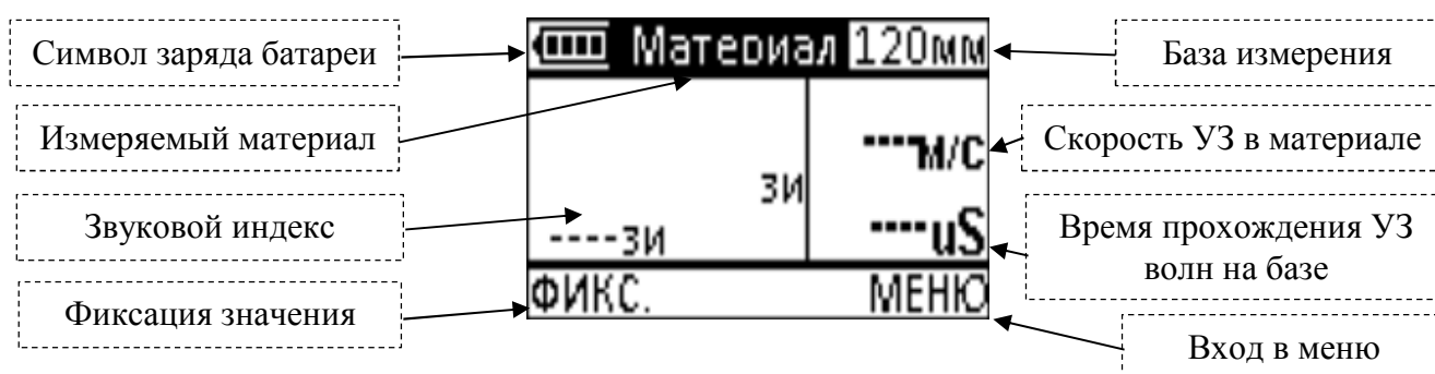
Рисунок 2.7 – Режим измерения звукового индекса
