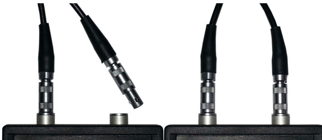
Рисунок 2.2 – Подключение преобразователей к прибору
