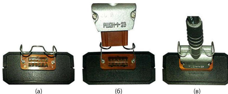
Рисунок 2.1 – Подключение преобразователя Холла
