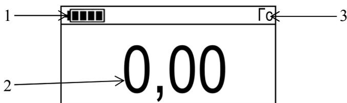
*1 – показатель заряда аккумуляторной батареи; 2 – значение измеряемой величины магнитной индукции; 3 – индикация единиц измерения.*
