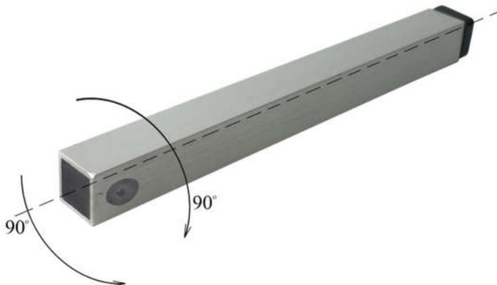
Рисунок 2.4 – Переворот преобразователя на  $90^\circ$  относительно своей оси
