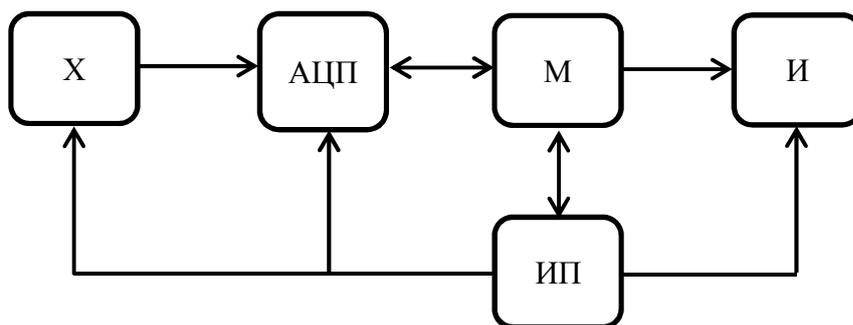
*X – линейный элемент Холла; АЦП – аналого-цифровой преобразователь;
