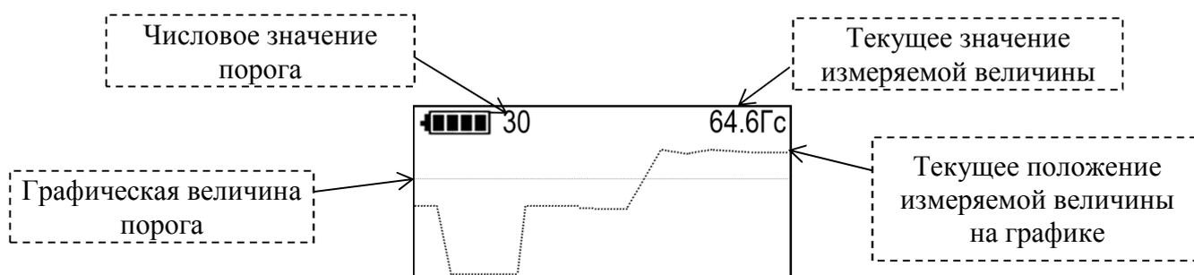
Рисунок 2.8 – Работа прибора в графическом режиме
