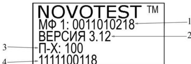
*1 – серийный номер прибора; 2 – версия программного обеспечения; 3 – тип преобразователя Холла; 4 – серийный номер преобразователя Холла.*
