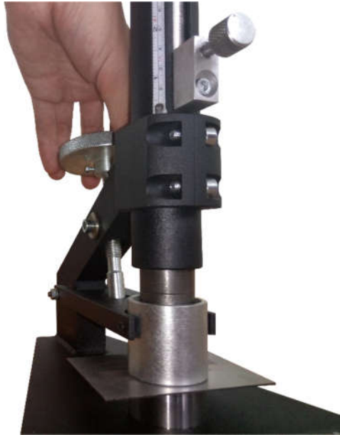
Рисунок 2.2 – Установка образца на наковальню
