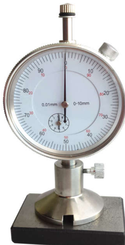
Рисунок 2.1 – Установка нуля глубиномера
