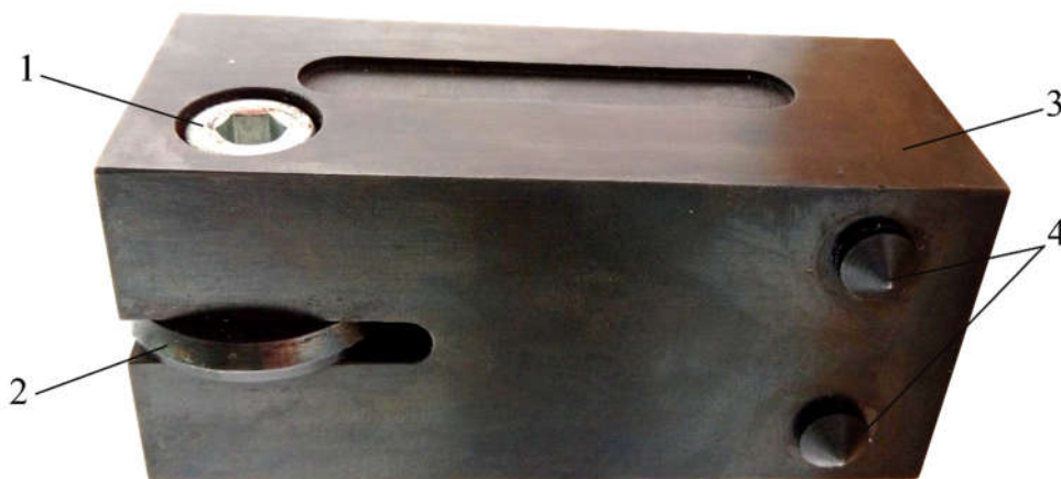
1 – винт фиксации индентора; 2 – индентор; 3 – корпус; 4 – заостренные ножки.
