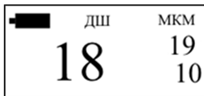
Рисунок 2.11 – Оценка шероховатости в режиме с усреднением
