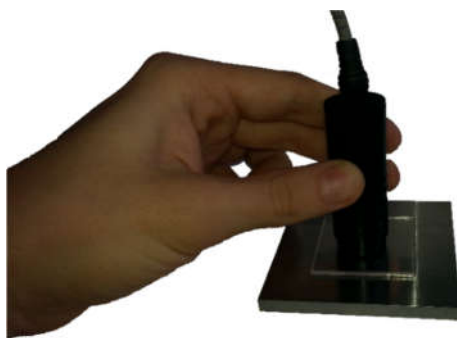
Рисунок 2.5 – Установка преобразователя на образец с покрытием
