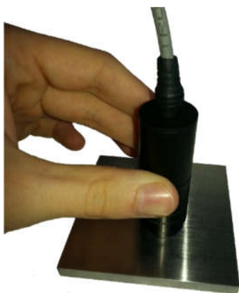
Рисунок 2.4 – Установка преобразователя на образец без покрытия
