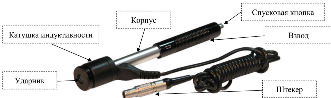
Рисунок 1.5 – Внешний вид преобразователя Д1С
