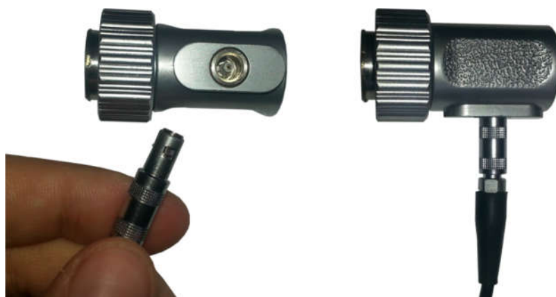
Рисунок 2.4 – Подключение совмещенного преобразователя к кабелю
