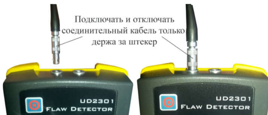
Рисунок 2.5 – Подключение совмещенного преобразователя к прибору
