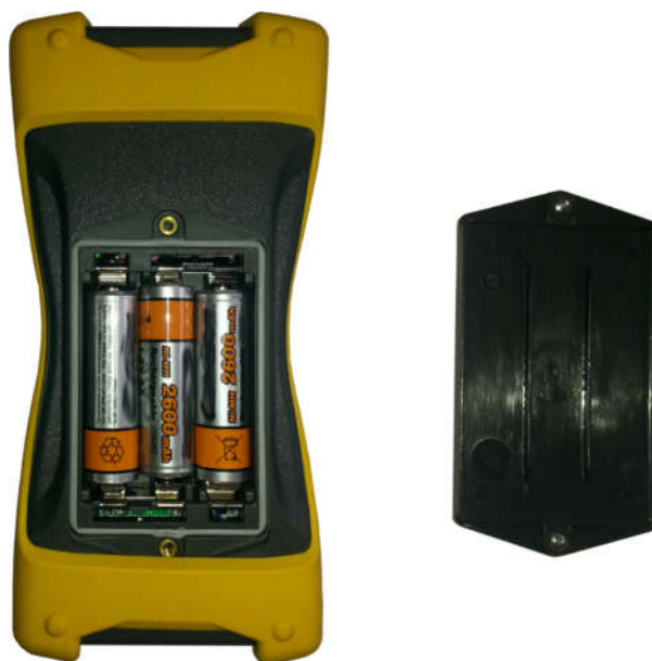
Рисунок 2.1 – Установка элементов питания
