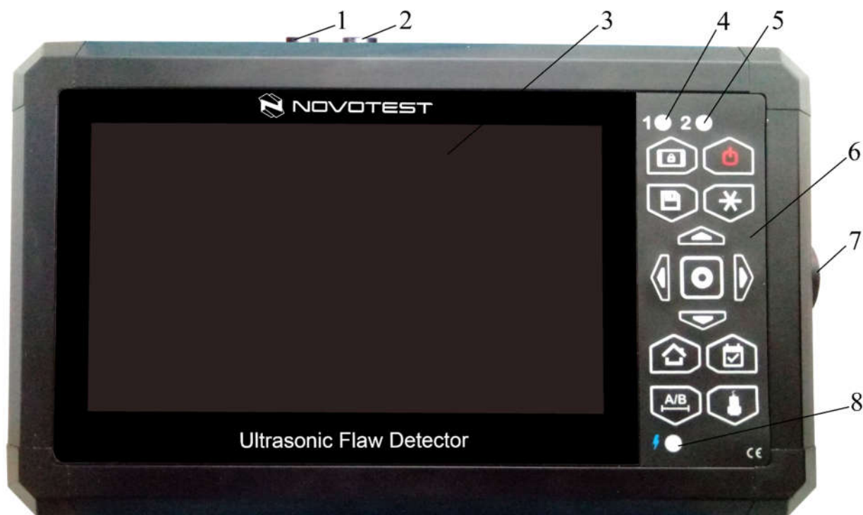
1 – разъем для совмещенного преобразователя и передающего пьезоэлемента; 2 – разъем для приемного пьезоэлемента; 3 – контрастный цветной тачскрин дисплей; 4 – индикатор строба А; 5 – индикатор строба В; 6 – клавиатура; 7 – разъем USB; 8 – индикатор аккумулятора.
