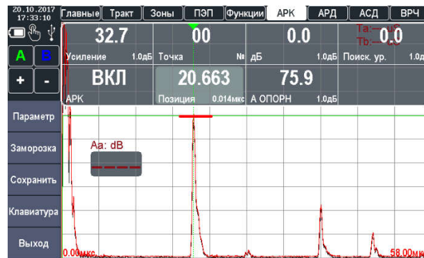
Рисунок 2.53 – Установка позиции первой опорной точки АРК
