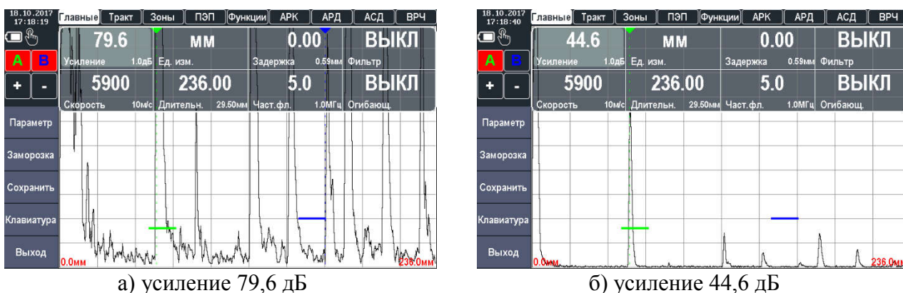
Рисунок 2.22 – Установка усиления приемного тракта
